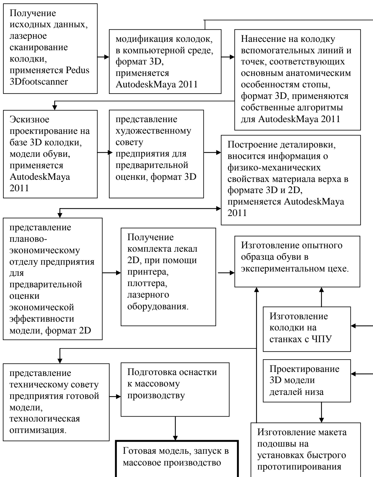
Рисунок 1. Структурно-логическая схема САПРО-3D
